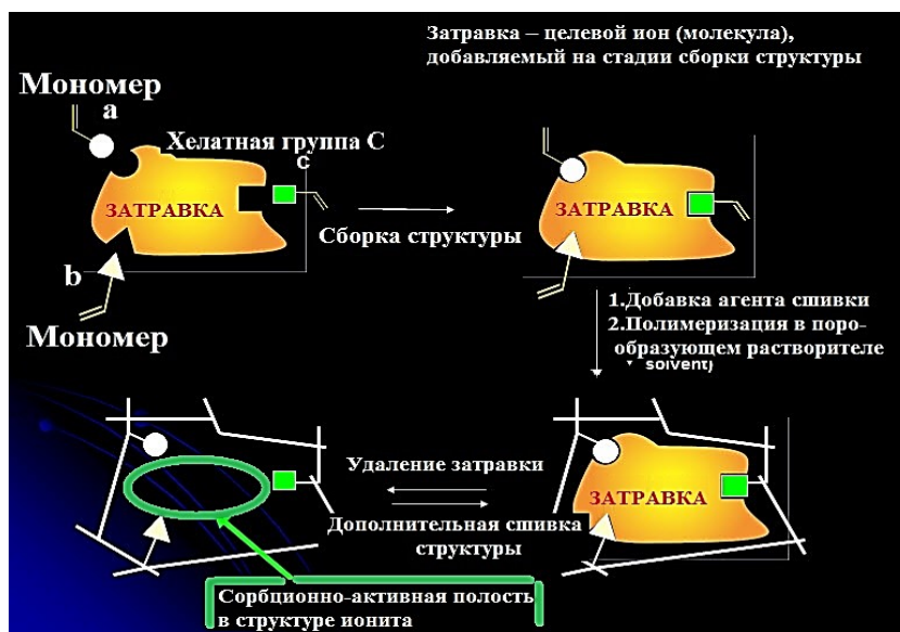
Рисунок 2. Блок-схема синтеза ионитов молекулярного распознавания с формированием матричной полости с сорбционно-активными группами (чаще всего хелатного действия). Форма полости в точности повторяет пространственную конфигурацию целевого иона (молекулы) [3]
