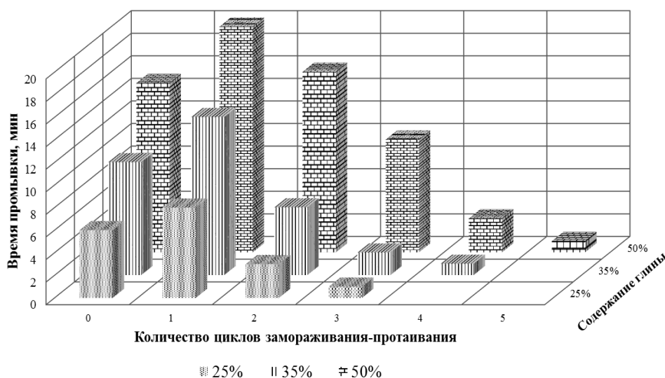
Рисунок 2. Время промывки образцов с заданной исходной влажностью 20% в зависимости от исходного содержания глинистых частиц и количества циклов замораживания-протаивания
